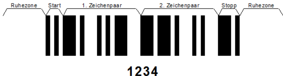
Abbildung 5.3.2.1.2-2. ITF-14 Symbol einschließlich der Ruhezonen
