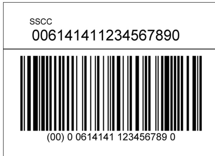
Abbildung 6.6.5-1. Basetikett mit SSCC
