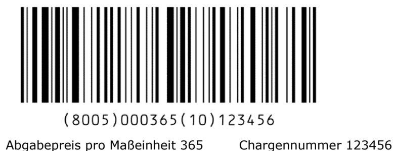
Abbildung 7.8.5.2-2. In einem GS1-128 Symbol verkettete Daten
