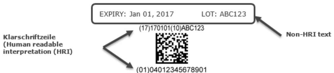
Abbildung 4.15-1. Beispiele zur Klarschriftzeile und zum Klartext
