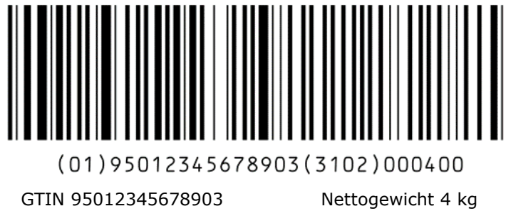
Abbildung 7.8.5.1-2. In einem GS1-128 Symbol verkettete Daten
