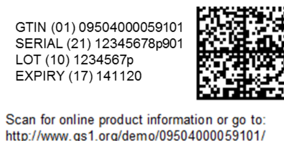
Abbildung 4.15.1-2. Kombinationen von HRI mit AIs, Non-HRI Text und Kurztitel – inkl. Beispiel URL
