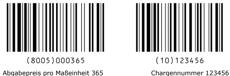
Abbildung 7.8.5.2-2. In einem GS1-128 Symbol verkettete Daten
