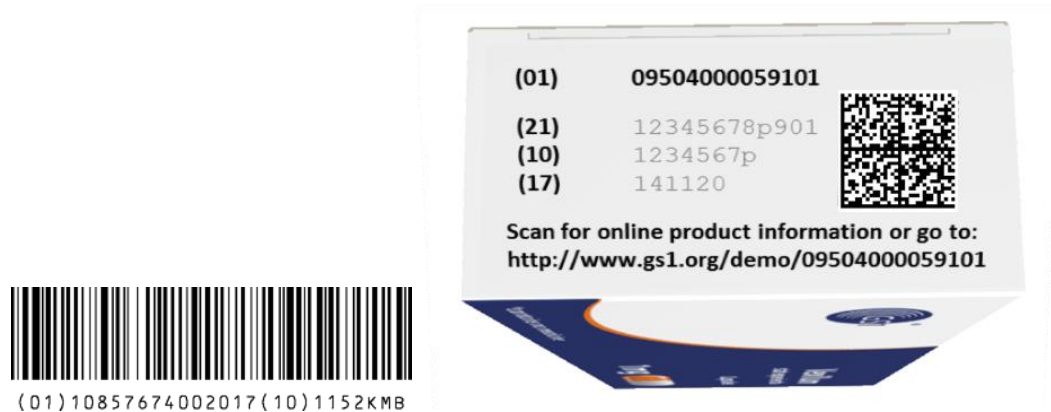
Abbildung 4.15.1-1. Beispiele von bevorzugten HRI Formaten – inkl. Beispiel URL
