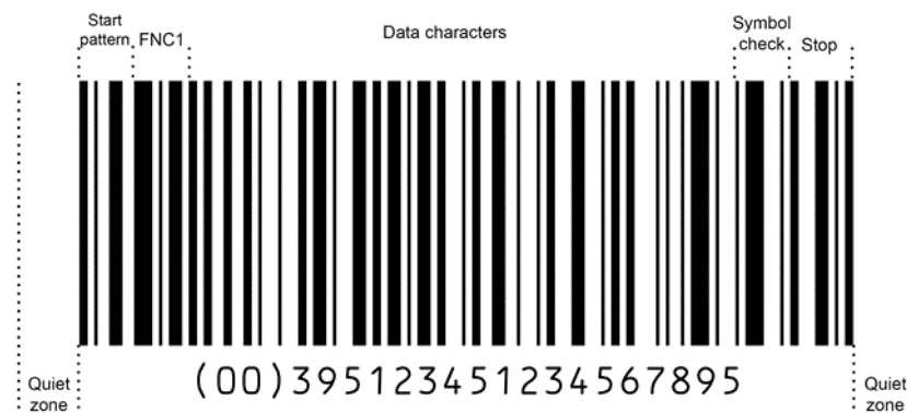
Abbildung 5.4.2-1. Allgemeines Format eines GS1-128 Strichcodes
