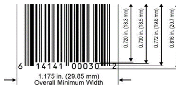
Abbildung 5.12.6.3-1. EAN/UPC Symbol angegeben mit der minimalen Höhe und der Gesamtbreite für eine Vergrößerung von 75% bis 80%
