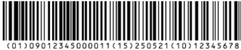
**Abbildung: Etikett (egalisiert), GS1-128 mit GTIN, MHD und Charge**
